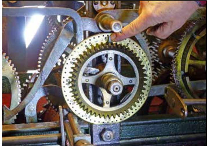
**Dieses Zahnrad hier sorgt dafür, dass die Turmuhr die Zeit anzeigt – seine beiden Kollegen links und rechts für den Glockenschlag, eine Konstruktion davor, dass alles zusammenläuft.**
