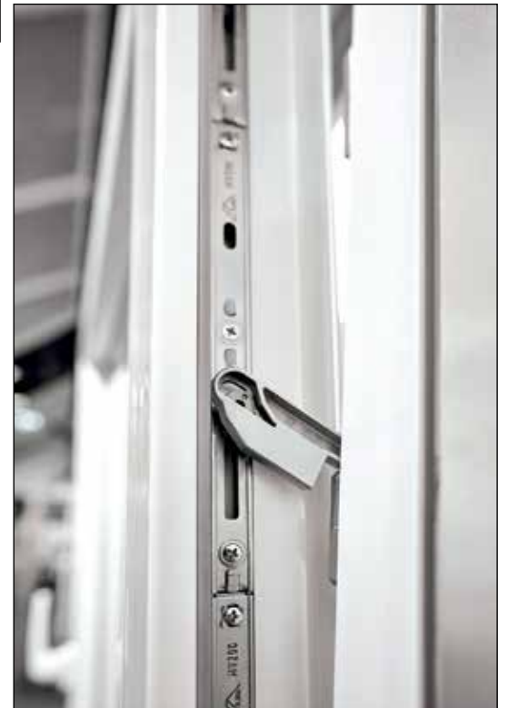
Prüfung eines einbruchhemmenden Fensters im Prüfinstitut Schlösser und Beschläge Velbert (PIV).
