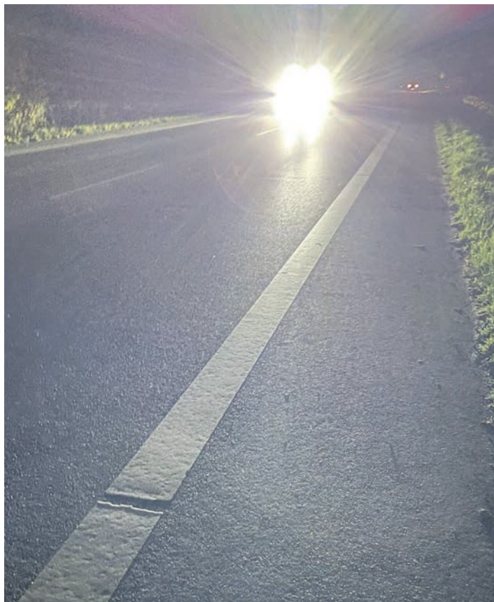
Auf dem Wehdenweg zwischen Wellingdorf und Schwentinental erkennt die Fernlichtautomatik dieses Autos ein entgegenkommendes Fahrrad trotz dessen vorschriftsmäßiger Beleuchtung nicht.
