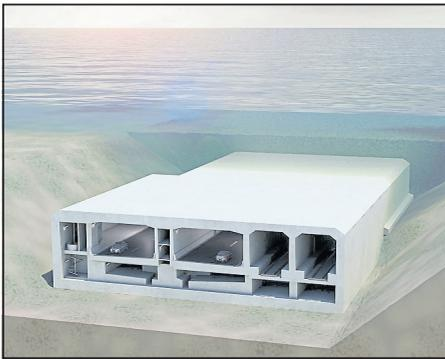
**Kopenhagen.** Der Fehmarnbelt-Tunnel zwischen Deutschland und Dänemark wird so sicher sein wie wenige andere Tunnel auf der Welt. Ein Grund sind die geplanten Untergeschosse in dem Bauwerk. Sie sind eine Weltneuheit beim Bau von Absenktunneln. Mit rund 18 Kilometern wird der Fehmarnbelt-Tunnel zwischen Puttgarden auf Fehmarn und Rødbyhavn auf der dänischen Insel Lolland der längste Tunnel der Welt für Autos und Züge – und der längste Absenktunnel der Welt.
