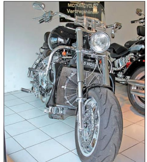
Die Herstellung von Boss Hoss Motorrädern erfolgt in Handarbeit, wobei nur V8-Motoren mit einem Hubraum zwischen 5,7 und 8,2 Liter verbaut werden. Mit einem Gesamtgewicht von über 500 Kilogramm sind die Motorräder extrem schwer.
