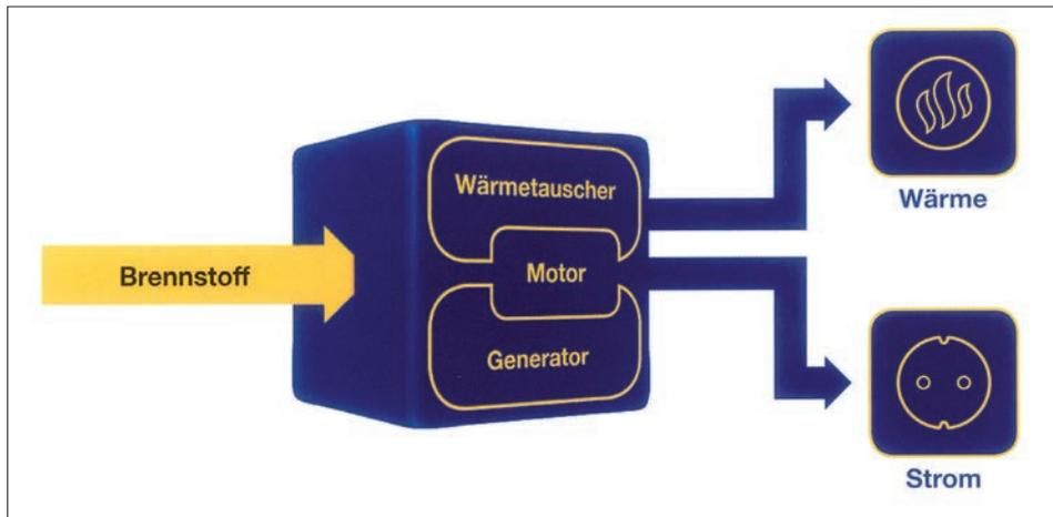
motor verbrannt. Die bei diesem Prozess frei werdende Bewegungsenergie treibt einen Generator an, der Strom erzeugt. Dabei entsteht Wärme. Das BHKW nutzt diese Wärme, indem es diese im Wärmetauscher einfängt und in einen Kreislauf überführt. So können Räume geheizt und Warmwasser bereitgestellt werden. Weil dadurch die eingesetzte Energie doppelt genutzt wird, sind BHKWs so effizient.
