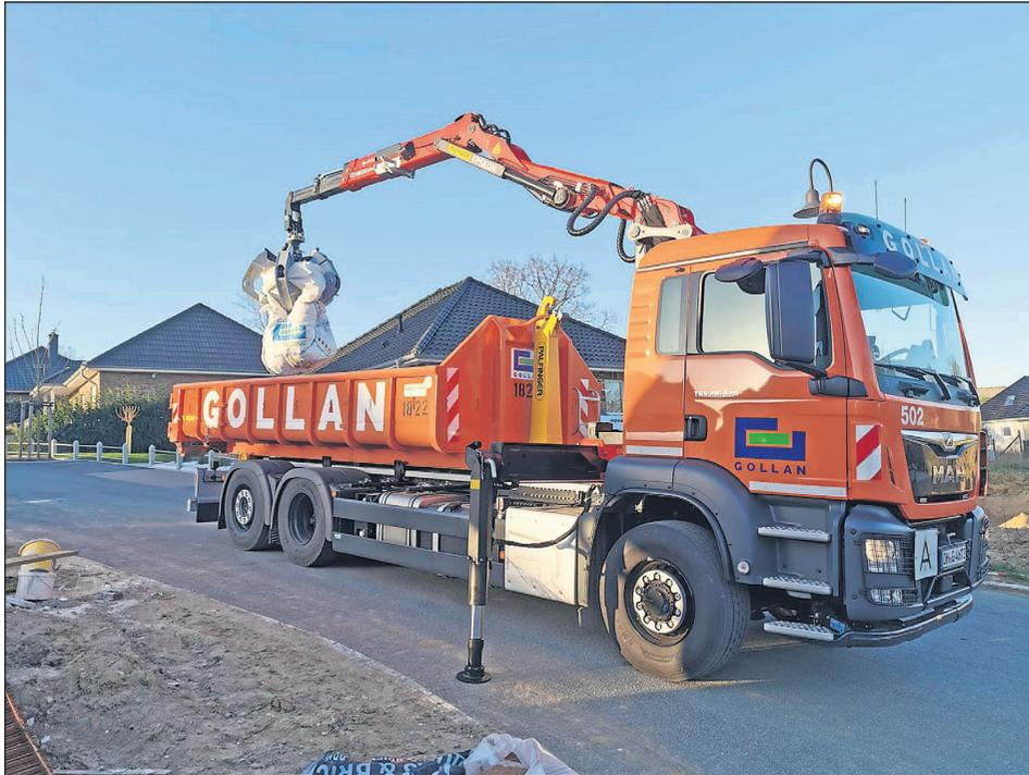
Der Kran hat eine Reichweite von bis zu neun Metern. Baggerarbeiten und Direktbeladungen sind mit einem Polypgreifer möglich.
