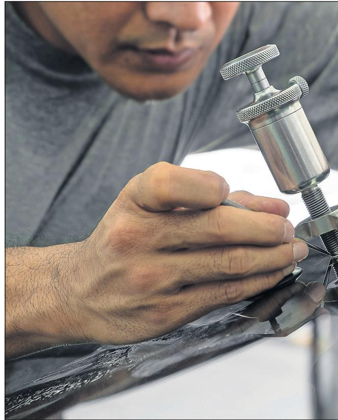
Nach einem Steinschlag lassen sich kleine Schäden außerhalb des Sichtfelds reparieren. Foto: ©Panitan/fo-tolia.com
