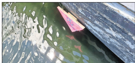
Durch die angebrachten Dreiecke kann ein weiteres Sinken auch aus der Ferne schnell erkannt werden.
