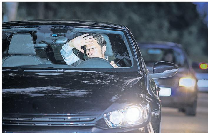
Sind Scheinwerfer zu hoch eingestellt, blenden sie den Gegenverkehr. Gemäß Licht-Test-Bilanz 2021 war das bei knapp neun Prozent der Fahrzeuge der Fall. (Foto: ProMotor/T.Volz)
