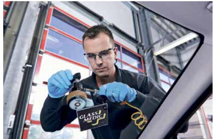
**Eine Reparatur der Frontscheibe ist immer möglich, wenn der Steinschlag nicht größer ist als fünf Millimeter, keinen Riss gebildet hat und nicht im Sichtfeld des Fahrers liegt.**
