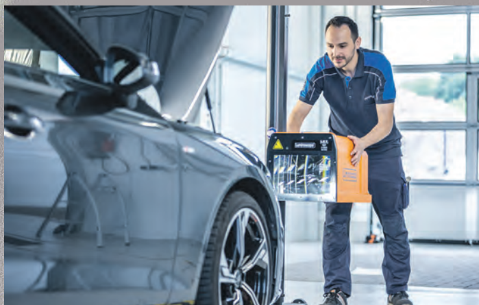
Sicher durch die dunkle Jahreszeit: Ein Sachverständiger von TÜV NORD kontrolliert die Fahrzeugbeleuchtung.
