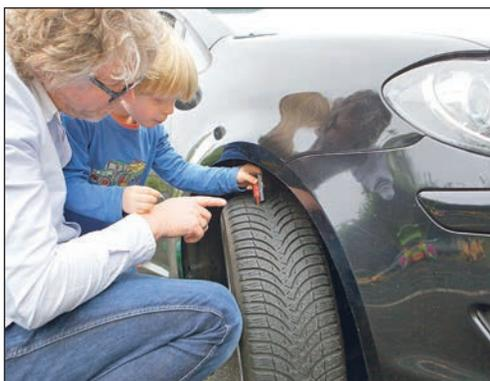
**Das regelmäßige Nachmessen muss sein: Denn Sommerreifen sollten mindestens eine Profiltiefe von 1,6 Millimetern aufweisen, Experten empfehlen den Austausch bereits bei drei Millimetern. Foto: djd/Delticom**
