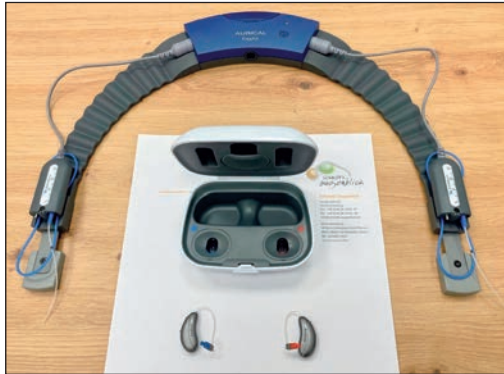
Modernste Messtechnik, wie hier das flexibel an die jeweilige Kopfgröße anpassbare Sondenmikrofonmessgerät (oben) sorgen für eine optimale Passgenauigkeit des Hörsystems (unten).
