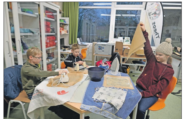
Jannes, Jan-Neo und Josie bügeln das Bienenwachs in die Fasern von Baumwolltüchern ein und stellen so ein wieder verwendbares, zu reinigendes Verpackungsmaterial her.
