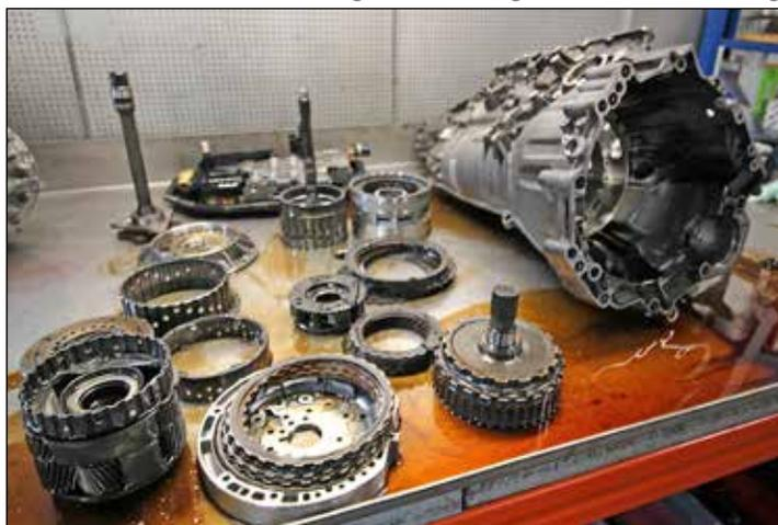
Ein fast zerlegtes Automatikgetriebe bestehend aus rund 150 Einzelteilen.
