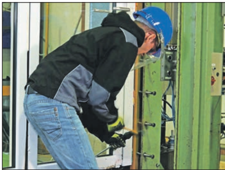
Prüfung eines einbruchhemmenden Fensters im Prüfinstitut Schlösser und Beschläge Velbert (PIV).
