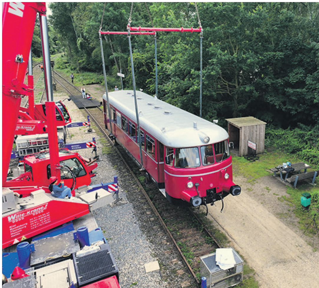
Präzisionsarbeit: Mit Hilfe zweier Kräne wurde der Schienenbus am 29. Juli in Lütjenburg auf die Gleise gesetzt. Foto: „Schienenverkehr Malente-Lütjenburg e.V./ Sylvia & Mathias Pank
