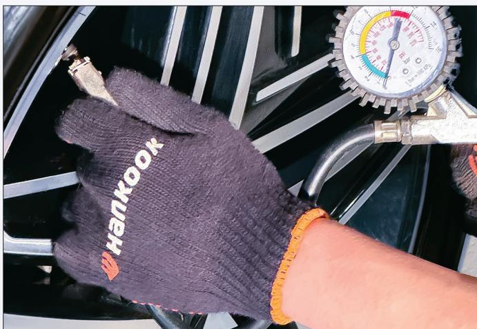
Vor dem Wechsel ist es ratsam, den Zustand der Reifen und den Druck der Pneu zu kontrollieren. Werkfoto: Hankook
