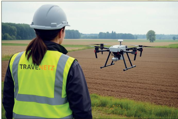
Die TraveNetz GmbH nutzt zur Überprüfung des Gasrohrnetzes auf mögliche Leckagen ein fortschrittliches Laser-Detektionsverfahren mittels Drohnen. (Foto: TraveNetz GmbH)
