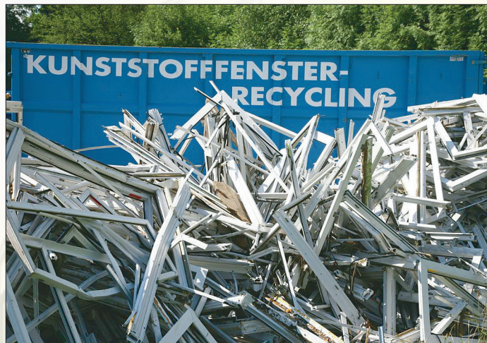
Das PVC in Kunststoffenfenster kann bis zu sieben Mal recycelt werden. Werkfoto: Rewindo/VFF
